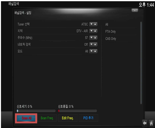
[그림 3] 다음과 같은 화면이 나타나면 “Tuner 선택”에서 “ATSC”로 맞춰주고 “Scan all”을 클릭합니다.
