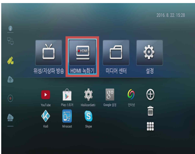
[그림 1] 입력기기와 출력기기를 HDMI 케이블로 연결시킨 후 HDMI 녹화기를 클릭합니다.
