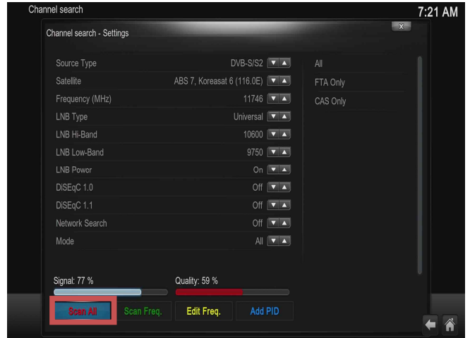
[그림 4] “Source Type”에서 “DCVB-S/S2, ATSC 또는 현지에 맞는 ”Source Type“를 선택하고 ”Satellite“를 원하는 위성으로 맞추 뒤 ”Scan All“을 클릭합니다.
